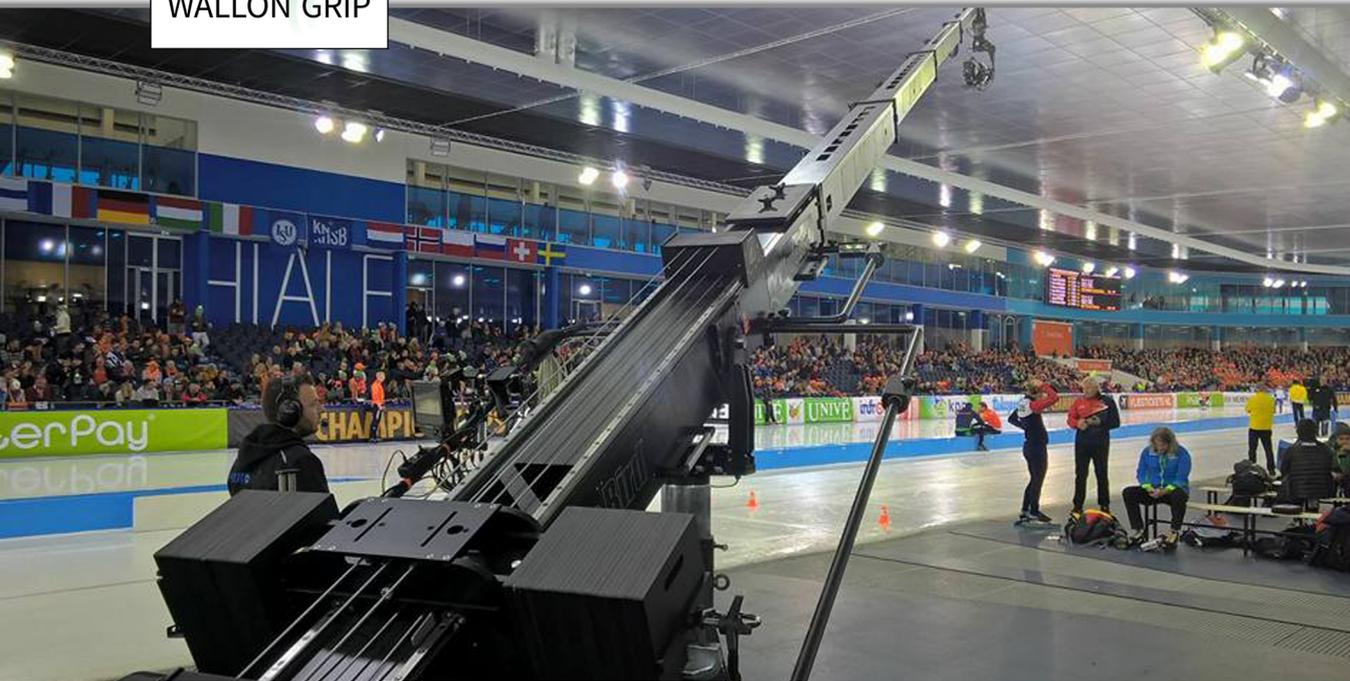
La MovieBird 45 est une grue télescopique polyvalente, adaptée à tous les plateaux de tournage ou les studios de télévision. La grue est universelle et, en fonction du poids de la caméra, est possible de modifier la longueur et de modifier la longueur maximale du bras entre 13,72 mètres et 10,67 mètres en quelques secondes. La MovieBird 45 est la grue la plus appréciée sur le marché à ce jour.
