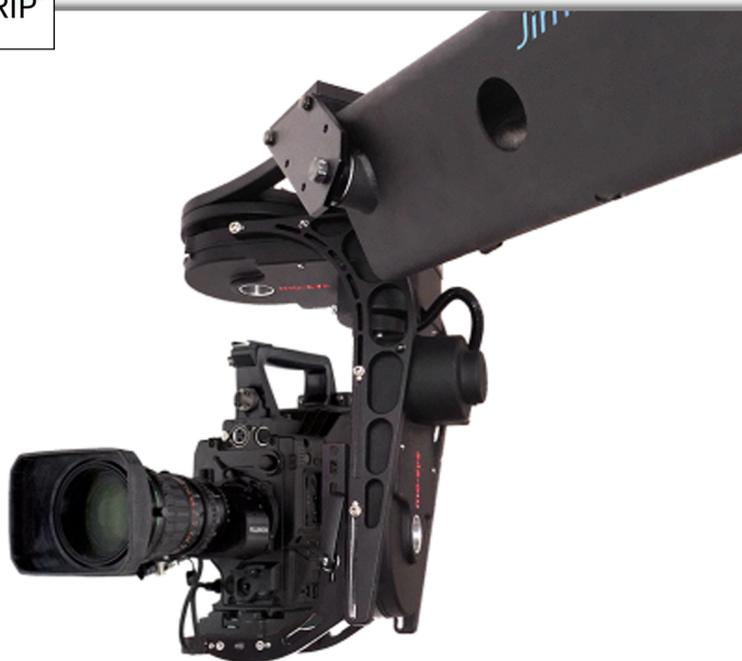
Spécialement conçue pour endurer la rigueur des applications de diffusion télévisuelle, la tête remote pan/tilt MO-SYS B20 est capable de fonctionner par câble ou sans fil.
