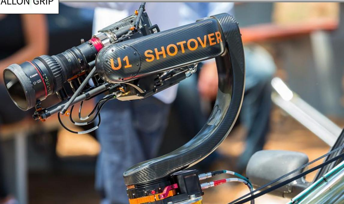
Le Shotover G1 est une plate-forme de cardan stabilisée, légère et résistante aux intempéries qui offre une stabilité extrême avec une fonctionnalité ultime. Le cardan Shotover G1 peut être monté sur la Flyline, une moto, différents véhicules, grues, câbles et presque tout ce qui bouge.
