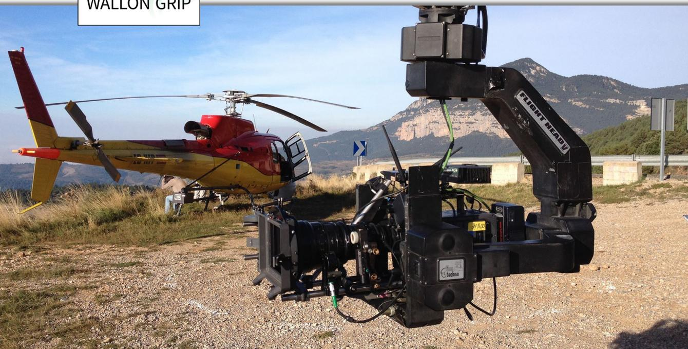
La conception gyro-stabilisée unique à 3 ou 4 axes de la Flight Head V élimine toutes les bosses et les vibrations, ce qui donne une image extrêmement lisse et stable (optiques Cinéma de 10 à 500 mm). La Flight Head V (FHV) offre un contrôle complet sur les fonctions de la caméra et de l'objectif.
