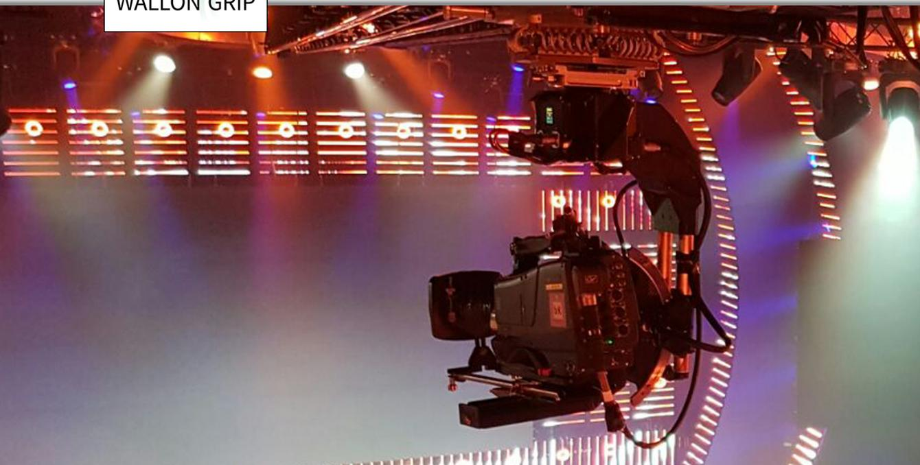
La FLIGHT HEAD CL est une nouvelle génération de têtes remote pour des caméras légères. Elle sait compenser une vibration angulaire de la caméra, assurant des images très stables et très lisses pour tous types de longues focales de 25 à 400 mm (objectifs cinéma).
