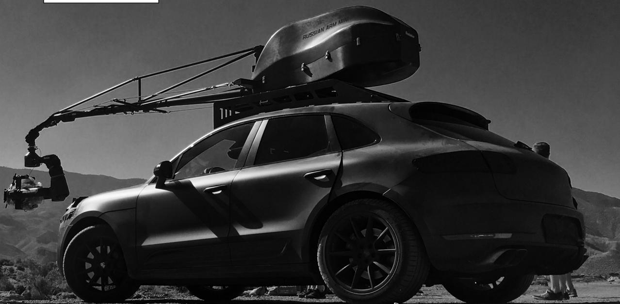
Le 'Russian Arm Dynamic' est une nouvelle génération de systèmes de grues robotisées gyro-stabilisées. La technologie de grue miniature gyro-stabilisée télécommandée est conçue pour être utilisée sur les petites voitures caméra, les voitures électriques ou autres petites voitures travelling. Et ceci pour une utilisation sur des routes étroites, des petits plateaux de tournages, des tunnels, des parkings, des ponts ...
